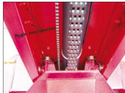
Kolumna podnośnika WERTHER MM25 z elementami ryglowania mechanicznego
