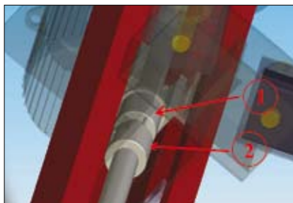
Układ nośny podnośnika WERTHER 255; 1 – nakrętka główna; 2 – nakrętka bezpieczeństwa
