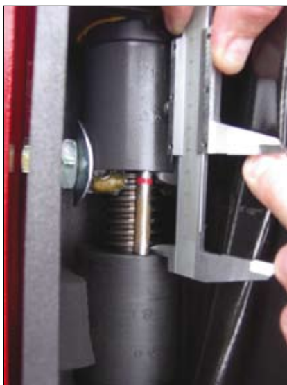
Kontrola zużycia nakrętki przez pomiar odległości
